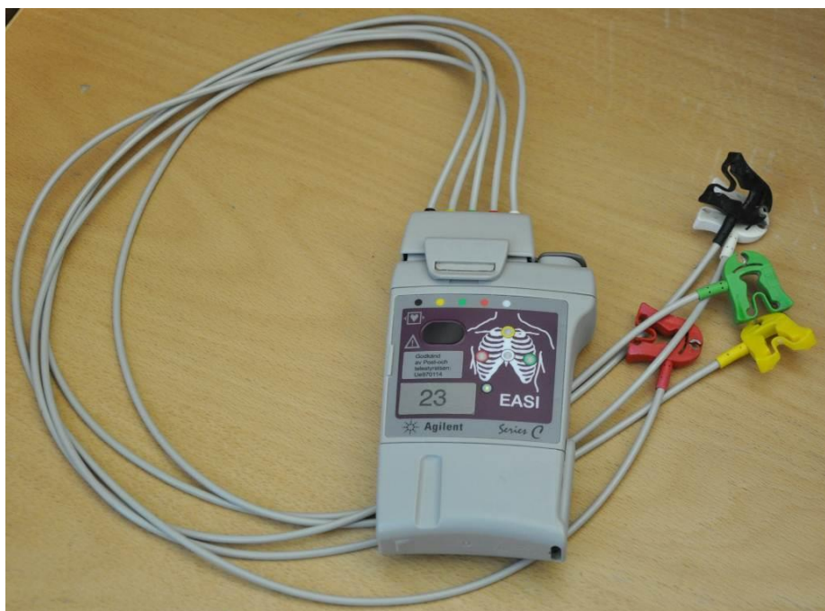
Fig. 6 Sändare för övervakning av EKG med telemetri.
