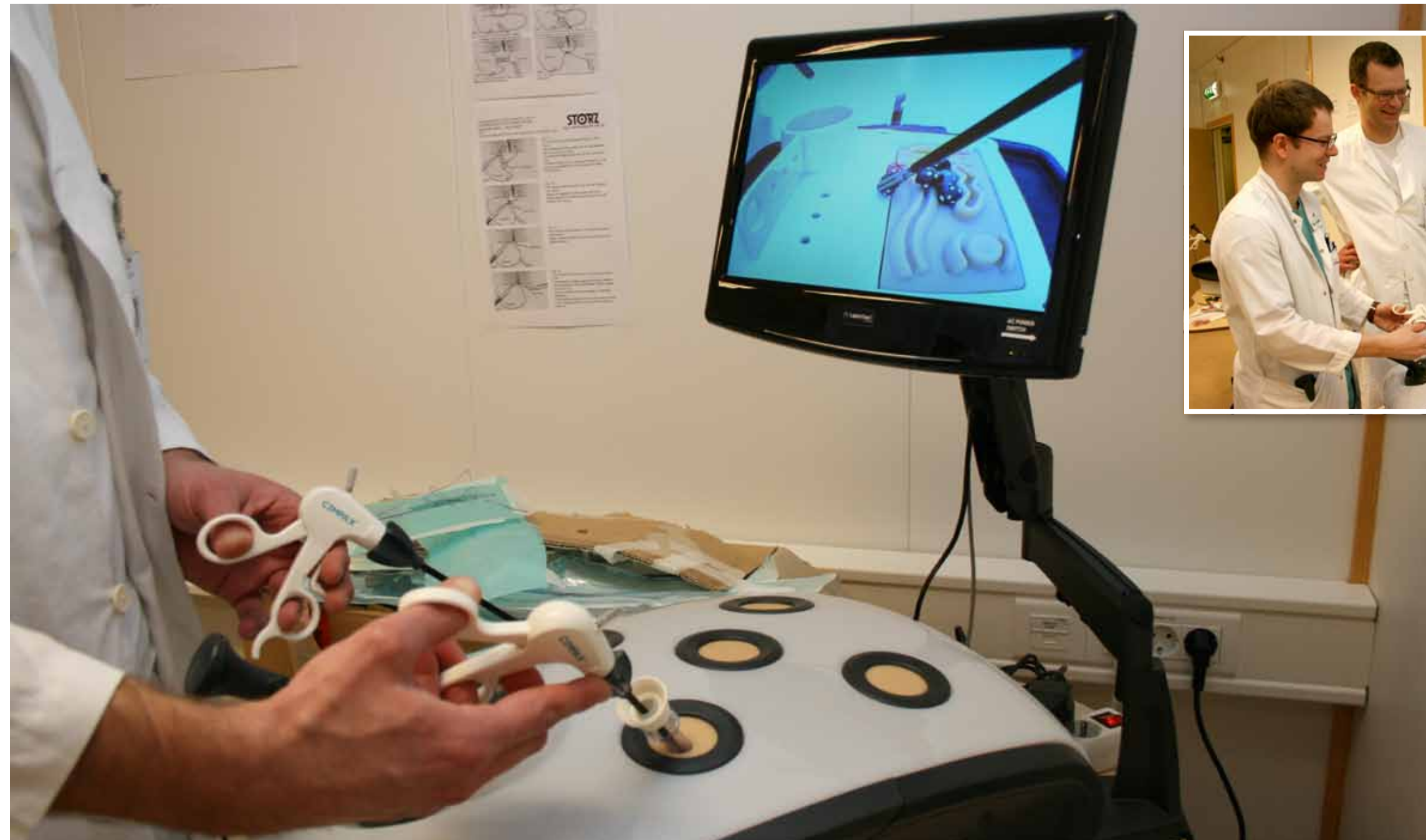
Simulatoren er plastboks med webkamera og skjerm. 40.000 kroner koster hver boks, noe som er en liten investering for en stor gevinst. Det mener Stig Müller.
